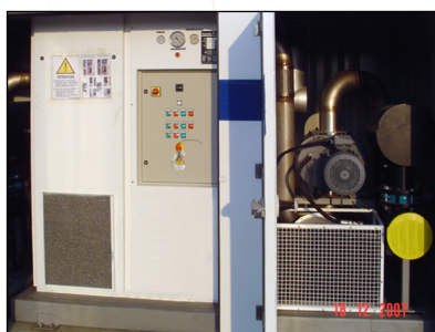
Насос UV16 Н с бустерным насосом Рутса
